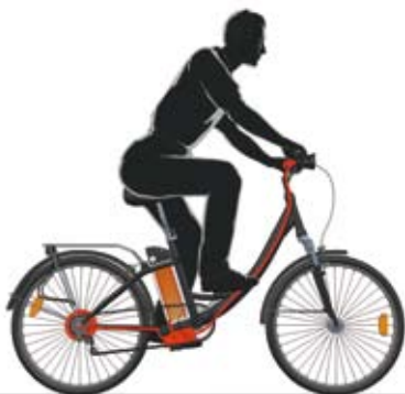
Schéma principu funkce elektrokola s elektromotorem v zadním náboji kola (snímač otáček)
