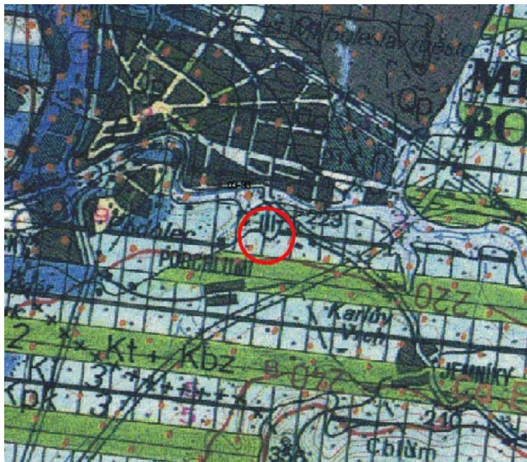
Výřez z hydrogeologické mapy (průlinovo-puklinový kolektor, prachovce, pískovce a slepence perucko-korycanského souvrství T 1 \cdot 10^{-4} - 1,45 \cdot 10^{-3} \text{ m}^2 \cdot \text{s}^{-1} )
